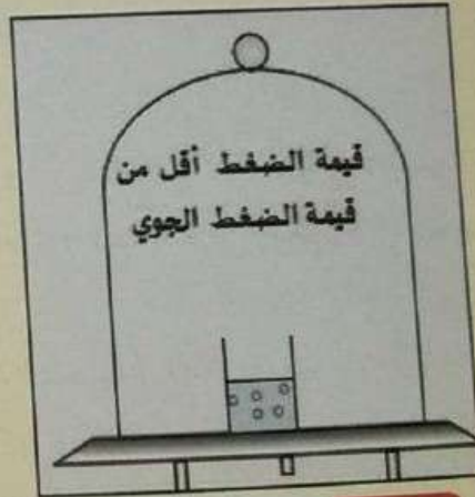
وثيقة 15 تجربة جهاز تفريغ الهواء
