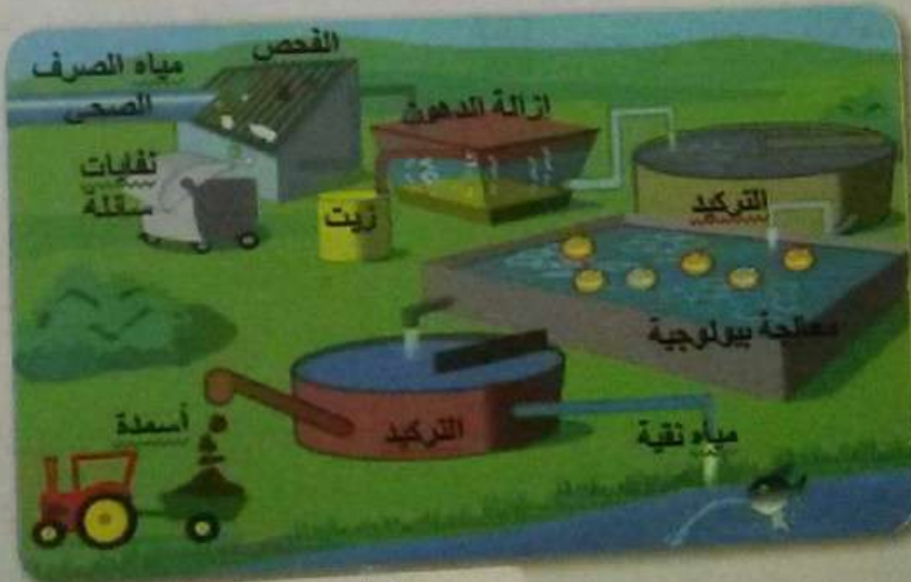
محطة تحلية مياه الصرف الصحي
